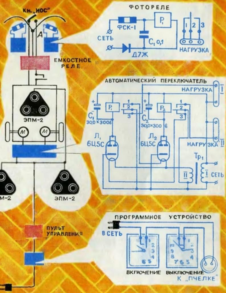
В схеме вы видите программное устройство. Это два будильника с электрическими контактами. Один в определенное время включает «Пчелку», другой выключает.
