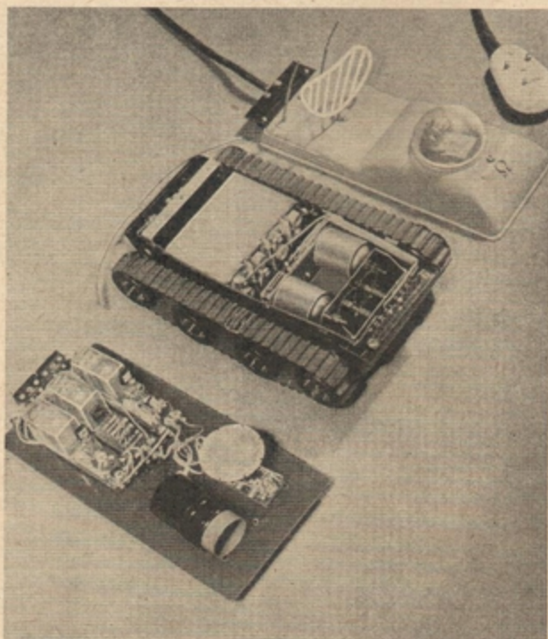
Bild 5: Links im Foto die Schaltplatte mit der Elektronik, in der Mitte das Fahrgestell, rechts die alte Abdeckhaube mit der Tastensteuerung
